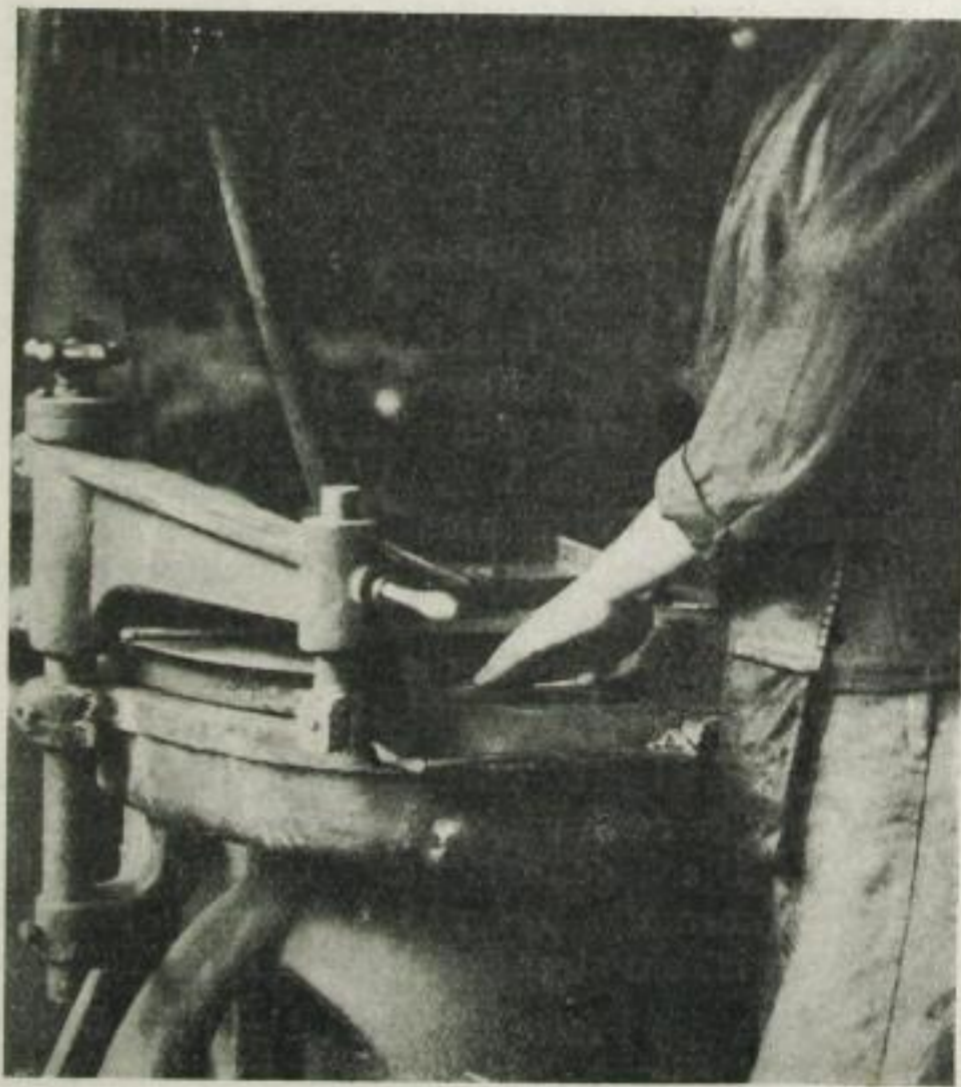
Das Fehlen von Schutzvorrichtungen am Schleifstein
