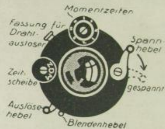
Abb. 1. Verschluss mit Spannhebel
