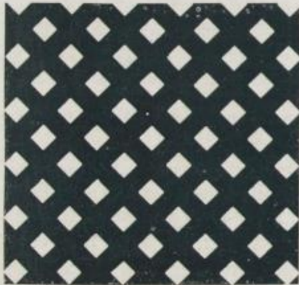
Abb. 3 Rasternetz Die beiden Abbildungen sind stark vergrößert — Erstere stellt ein Originalrasternetz mit den weißen Fensterchen dar. Abb. 4 ist ein Ausschnitt eines Rasternegatives, auf der die verschieden große Punktbildung deutlich erkenntlich ist
